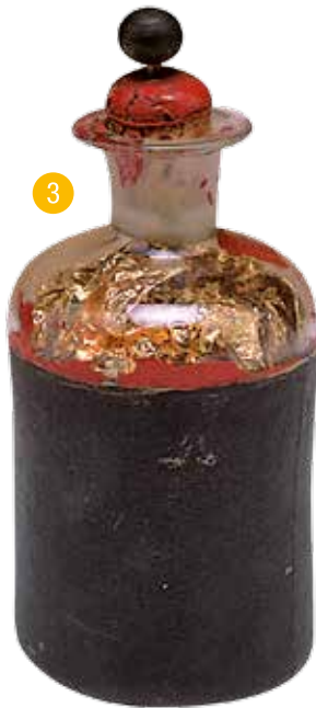
Botella de Leiden (1850-1860). Observa cómo su interior está relleno con láminas de oro.
