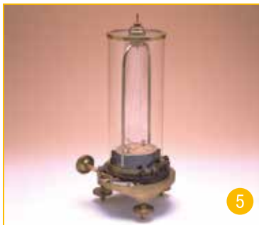
Galvanómetro astático de Nobili (1845-1880)
