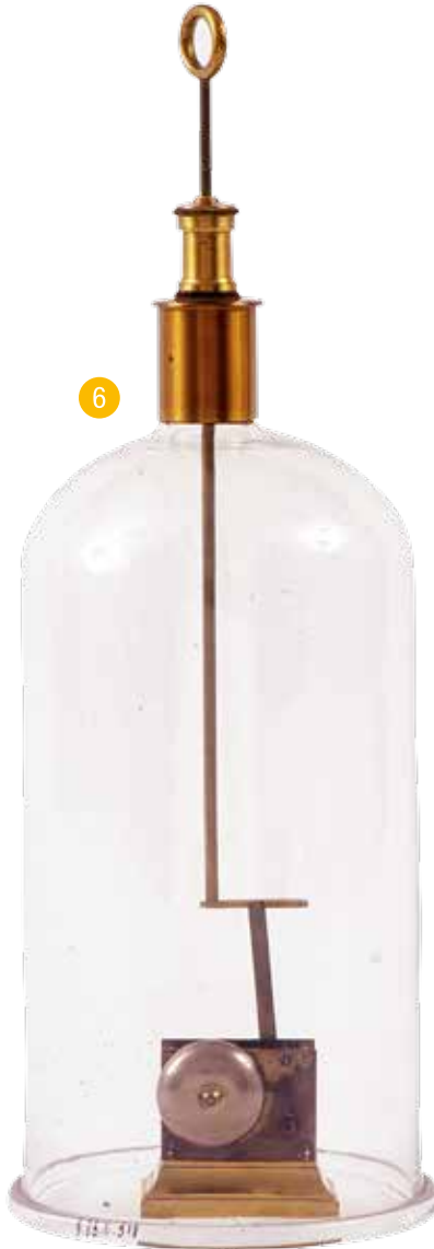
Campana de vidrio y timbre para experiencias de propagación de sonido en el vacío (siglos XVIII-XIX)
