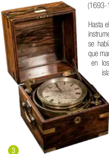
3 Cronómetro marino construido por J. R. Losada (hacia 1850). Está provisto de un sistema de suspensión que amortigua movimientos bruscos, como los que se producen al disparar los cañones.
