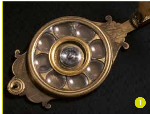
Este instrumento es un microscopio simple construido hacia 1700. Es muy similar a una lupa. En su interior aloja una rueda con lentes diferentes que se pueden seleccionar.
